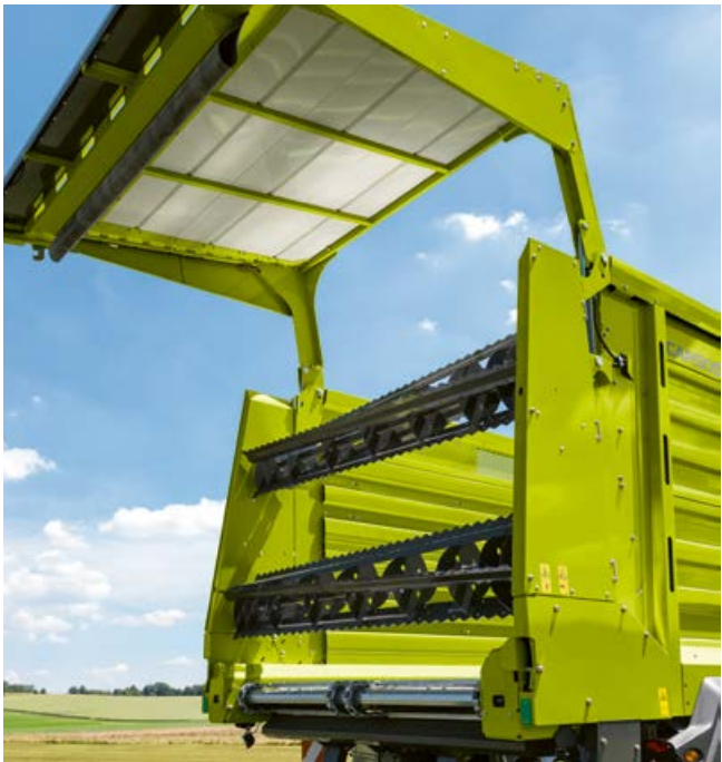
Snelle demontage van de module voor meer laadruimte en een gewichtsvermindering van ca. 500 kg.
