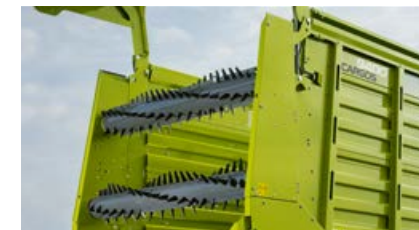
Module met twee rollen voor de combi-wagen
