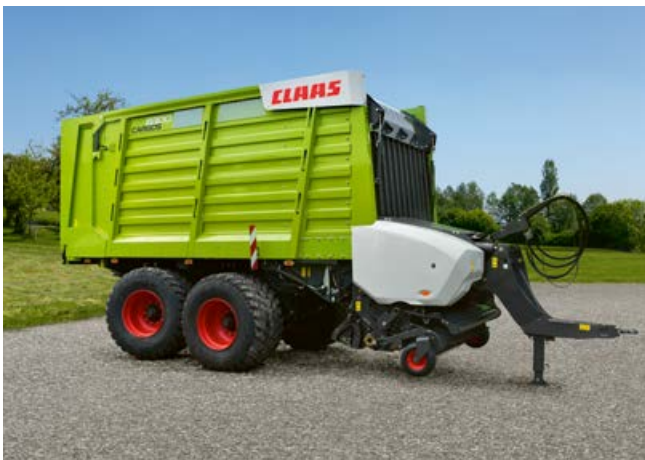
Afhankelijk van de specificatie per land kan een CARGOS met een EU-type-goedkeuring naar keuze worden uitgerust met of zonder spatborden.
