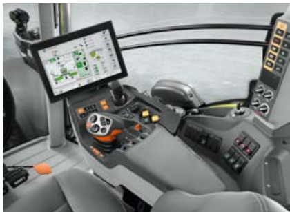
Wanneer de tractor is uitgerust met een ISOBUS-compatibele terminal, kan de voorkeuzebediening voor CONTOUR rechtstreeks op deze terminal worden uitgevoerd.
