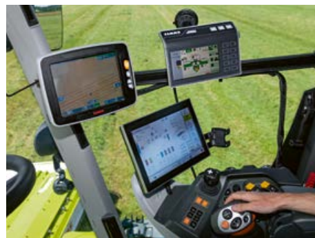
Eenvoudige bediening, bijvoorbeeld met verschillende ISOBUS-terminals en ISOBUS-functietoetsen op de rijhendel.
