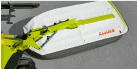
Activeren van de mechanische botsbeveiliging. Bij een botsing wijkt de machine schuin naar achter en ook licht naar boven uit. DISCO 1100 TREND beschikt over hydraulische non-stop botsbeveiliging.
