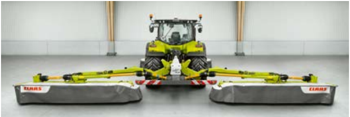
Twee hydraulisch regelbare, telescooparmen met traploze instelling voor optimale overlap bij DISCO 1100 TREND.
