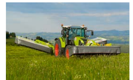
Dankzij de compacte ophanging aan de frontheft beschikt de maaier over veel bodemvrijheid op de kopakker.
