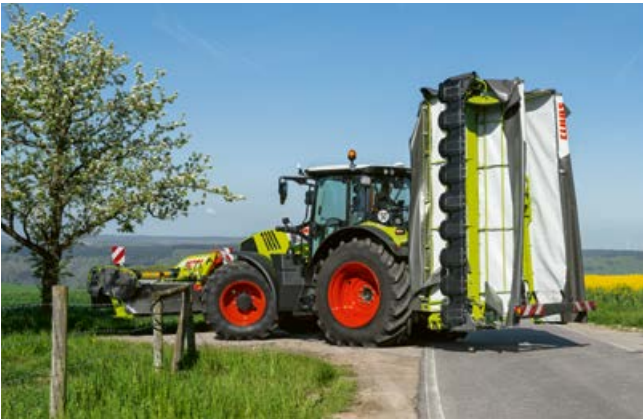
Bij alle DISCO modellen worden de beide maai-units in elkaar geschoven voor een compacte transportstand onder 4 m.
