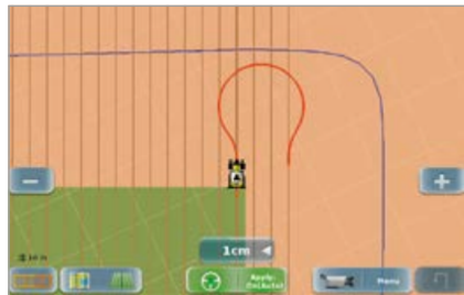
Met AUTO TURN keert de tractor automatisch op de kopakker
