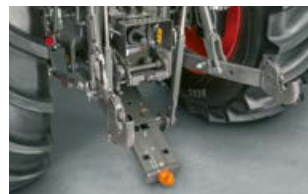
Als alternatief voor de aankoppelbok is een oppikhaak leverbaar.
