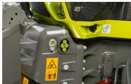
Externe bediening van de fronthef en een regelventiel (afhankelijk van de uitvoering).
