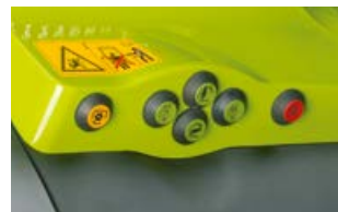
Externe bedieningselementen voor de achterhefinrichting, aftakas en een te kiezen regelventiel (alleen met CEBIS).
