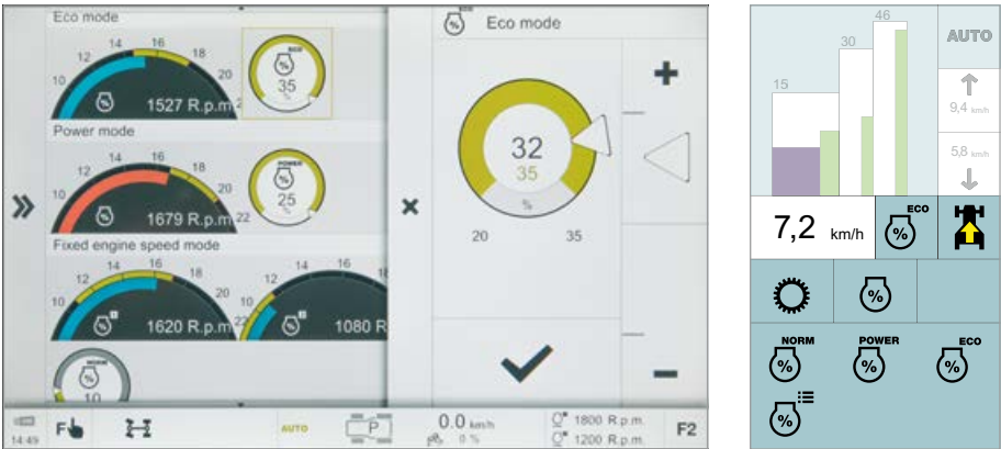
Instelling van de motordrukking voor „Eco“ en „Power“, evenals het motortoerentalgeheugen
