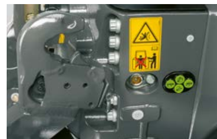
Externe bediening voor de fronthef en een regelventiel
