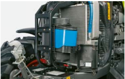
Voor de radiator geplaatst motor luchtfilter is vanaf de grond goed bereikbaar.
