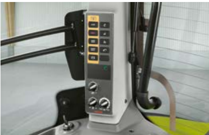
Aftakassnelheden en elektronisch geregelde hefinrichting op de B-stijl in te stellen.
