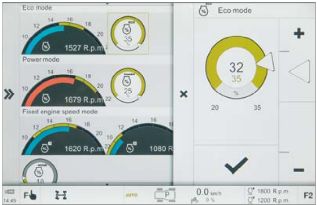
Instelling van de motordrukking voor „Eco“ en „Power“, evenals het motortoerentalgeheugen
