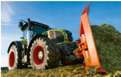
In combinatie met de frontheinrichting zijn max. twee dubbelwerkende regelventielen en een vrije retour aan de voorzijde leverbaar. Ideaal voor een zaadtank of een schuifblad in de fronthef.
