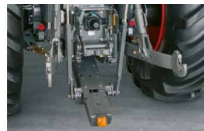
Een oppikhaak is als alternatief voor de ISO-500 conforme aanspanbok leverbaar.
