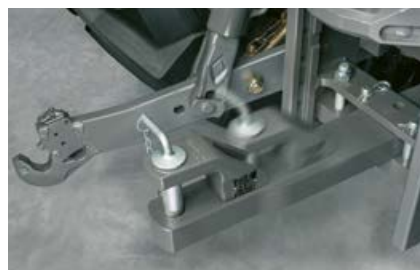
Varianten van de zwaaihaak kunnen in meerdere posities worden bevestigd. De uitgetrokken positie zorgt voor een betere wendbaarheid.
