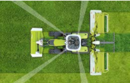
Door de speciale opstelling van de achterste cabinestijlen en de gebogen achterraut heeft de bestuurder een perfect zicht op het werktuig en de aanbouwruimte.
