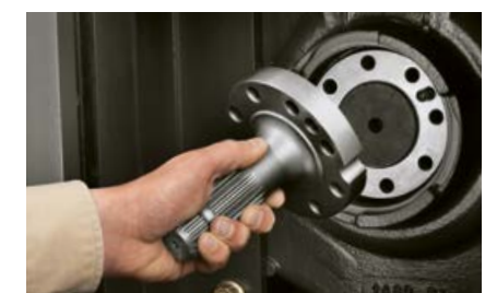
Eenvoudig verwisselen van de aftakasstomp.
