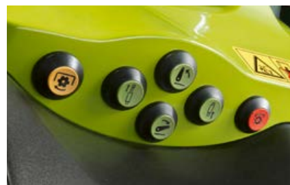
Externe bedieningselementen voor de achterhefinrichting, aftakas en een te kiezen regelventiel.
