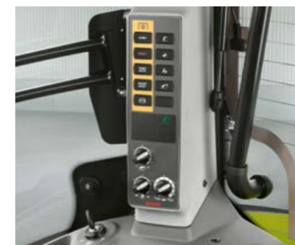
Aftakasselheden en elektronisch geregelde hefinrichting op de B-stijl in te stellen.
