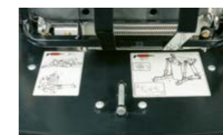
Onder de motorkap bevindt zich een smeerschema, die het onderhoud eenvoudiger maakt.
