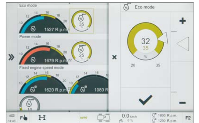
Instelling van de motordrukking voor "Eco" en "Power", evenals het motortoerentalgeheugen.
