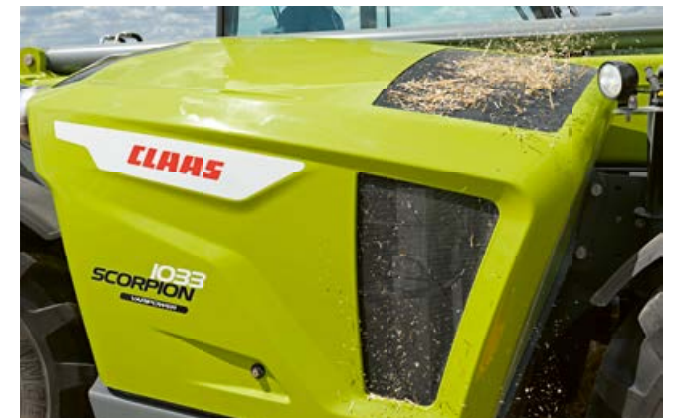
Minimale koelervuiling dankzij omkeerbare ventilator.
