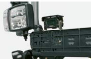
Een hoge resolutie camera aan de voorzijde levert ook bij weinig licht scherpe beelden.
