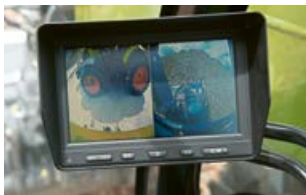
De beelden van de voor- en achteruitrijcamera worden op de monitor in de cabine weergegeven.
