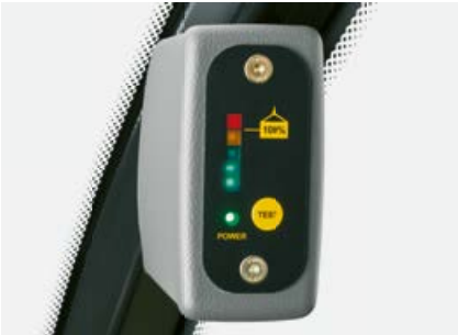
Lastweergave met duidelijke stoplichtsymboliek: is de stabiliteitsgrens overschreden, lichten alle LED's op en er klinkt een waarschuwingsgeluid.
