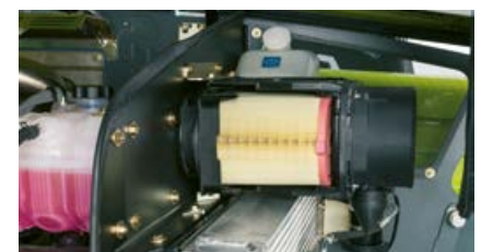
Het motorluchtfilter is zeer goed toegankelijk en kan zonder gereedschap worden onderhouden.
