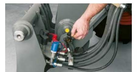
Stekkers voor flexibele stroomverzorging van verschillende aanbouwwerktuigen.
