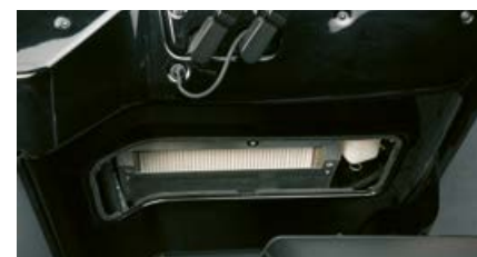
Goede toegang tot het luchtfilter voor de cabine.
