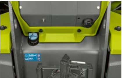
Goed bereikbare AdBlue-vulopening voor efficiënte uitlaatgasnabehandeling.
