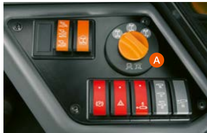
Draai-drukschakelaar (A) voor keuze stuurmodus bij SCORPION VARIPOWER.
