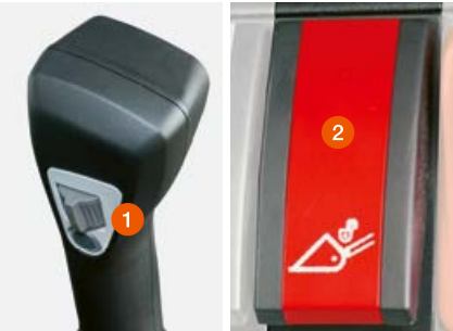
Snel en veilig wisselen van werktuig met knop (1) en tuimelschakelaar (2).
