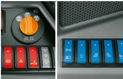
Kleurgecodeerde groepering van de bedieningselementen voor een maximum aan comfort en veiligheid.
