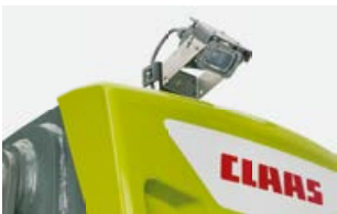
De PROFI CAM aan de achterzijde ziet alles, wat zich achter de rug van de bestuurder afspeelt.
