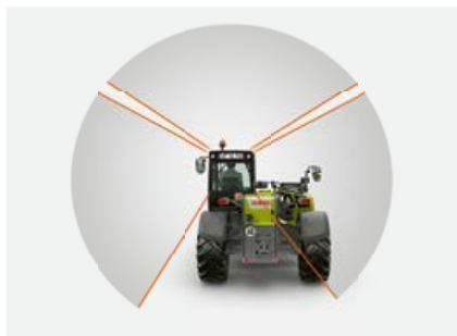
Ongehinderd zicht naar achteren voor meer werkveiligheid, door diep bevestigde telescooparm.
