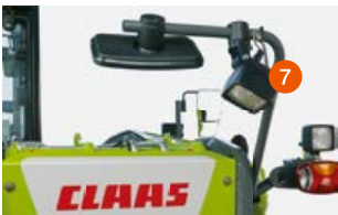
Halogeen-werklamp op de houder van de achterspiegel voor verlichting van de achterzijde.
