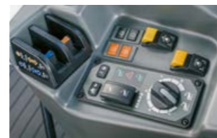
U kunt kiezen tussen de mechanische en de elektronische regeling van de hefinrichting achter. Beide zijn ergonomisch en gunstig geplaatst rechts naast de bestuurdersstoel.
