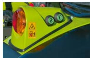
Handige externe bediening met mechanische of elektronische hefinrichting achter.
