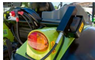
Handige externe bediening met mechanische of elektronische hefinrichting achter.
