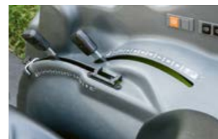
U kunt kiezen tussen de mechanische en de elektronische regeling van de hefinrichting achter. Beide zijn ergonomisch en gunstig geplaatst rechts naast de bestuurdersstoel.
