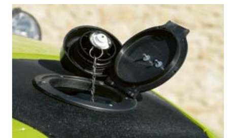
Praktisch is de opklapbare opening in de motorkap. Daardoor kan de goed beschermde eronder liggende tank gemakkelijk worden geopend en gevuld.
