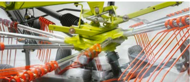
Dankzij de cardanische ophanging passen de rotoren zich aan de bodem aan, onafhankelijk van de tractor.
